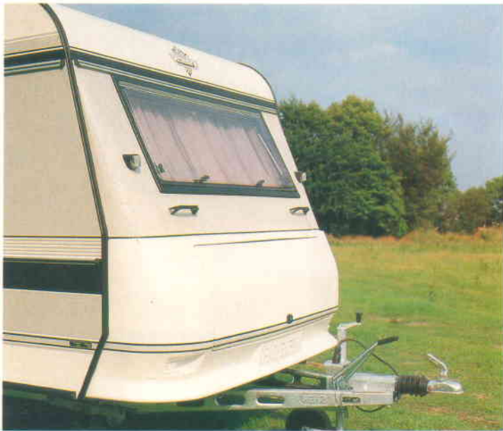
Großraum-Flaschenkasten, vom Aufbau getrennt, über ganze Wagenbreite.
