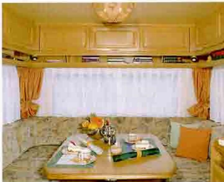
Holz „atmet“ und passt sich unterschiedlichen klimatischen Bedingungen auf natürliche Weise an. Deshalb wurde im Diamant nur Echtholz verarbeitet. Vom fünf-fach verleimten Sperrholz für Trägerplatten bis zu den edlen Furnieren und massiven Möbelementen. Auch Decke und Wände sind edelholz furniert.
