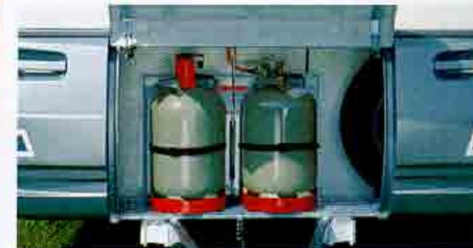
Zusätzlichen Stauraum bietet der Flaschenkasten (für 2 x 11 kg Gasflaschen und mit Reserveradhalterung). Der Deckel lässt sich durch Teleskoparme bequem nach oben klappen.
