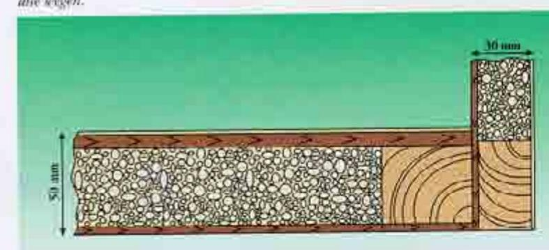
Fendt-caravans imponeren niet alleen op het eerste gezicht. De kwalitatief hoogstaande bouwstaander garandeert een aangename ambiance: de binnendelen die u niet ziet zorgen voor optimale stabiliteit: alle draagvlakken en muurvlakken zijn niet van spaanplaat maar van gedrukte sperrholzplaten. Dat is kwaliteit die een meerwaarde oplevert.
